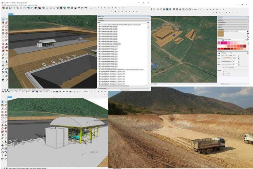
ภาพตัวอย่างงานดินบนภูเขาที่เราใช้ SketchUp ออกแบบและคำนวณปริมาตรดินขุดและดินถมอย่างแม่นยำ
